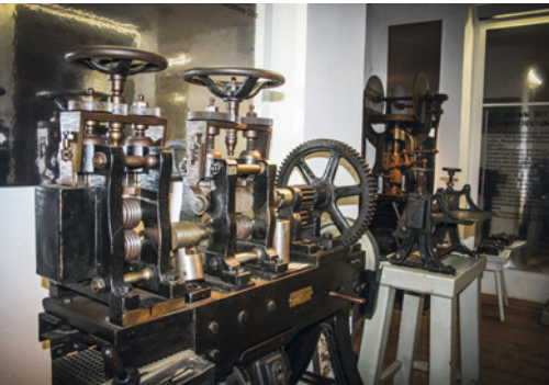
Maschine zum Auswalzen von Gold und Silber ... Maschine zum Ziehen von Gold- und Silberdrähten ... wenig Platz: Arbeitsplatz für drei Goldschmiede
