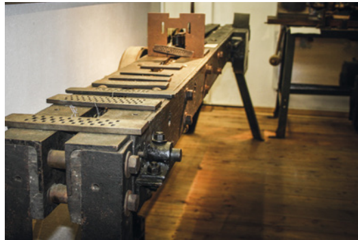
Maschine zum Auswalzen von Gold und Silber ... Maschine zum Ziehen von Gold- und Silberdrähten ... wenig Platz: Arbeitsplatz für drei Goldschmiede
