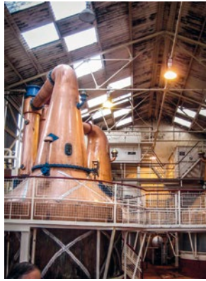
Die Brennblasen (wash stills) sind Unikate aus Kupfer, jede Destillerie hat eigene Formen
